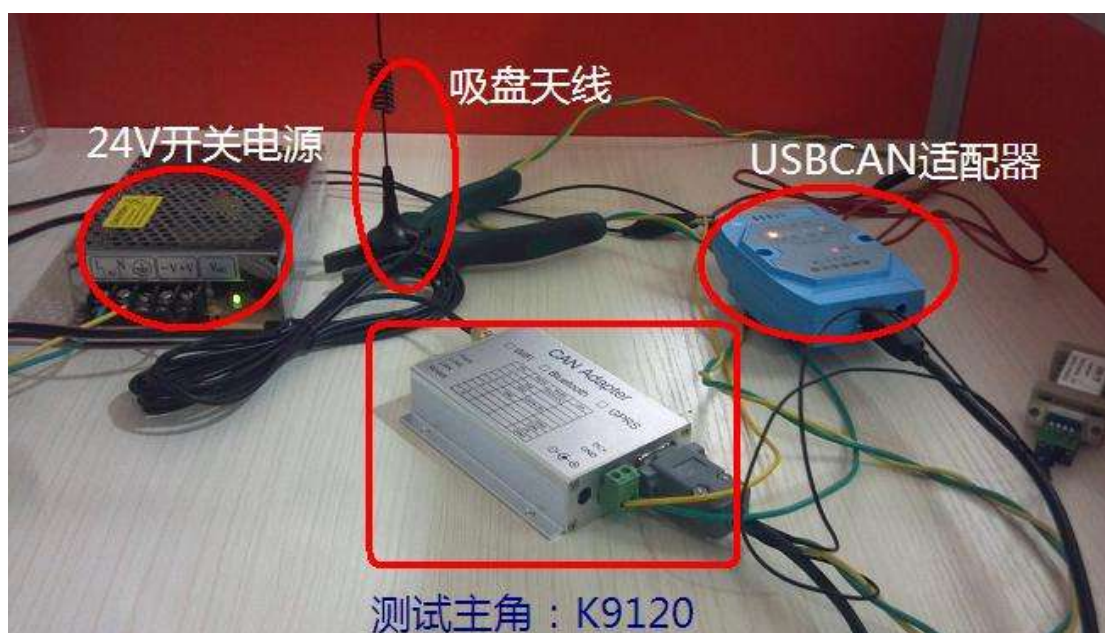
连接测试设备，给 K9120 CAN-to-GPRS 适配器供电
