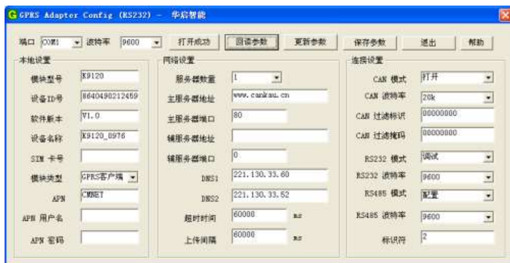
调用配置程序配置 K9120 CAN-to-GPRS 适配器参数
