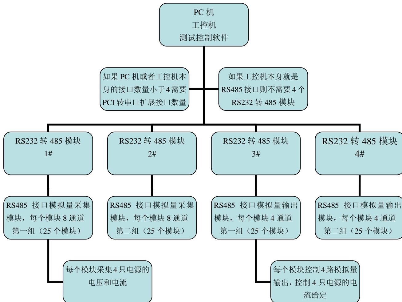
**说明：**每个电源独立使用一个控制端可以最大限度保证控制的稳定性和可靠性，每个电源的控制也是独立的。测试的时候电源的控制参数是一致的情况下，电源电流控制部分可以根据负载情况调整模块数量，如果负载小可以多个电源共用控制端。
