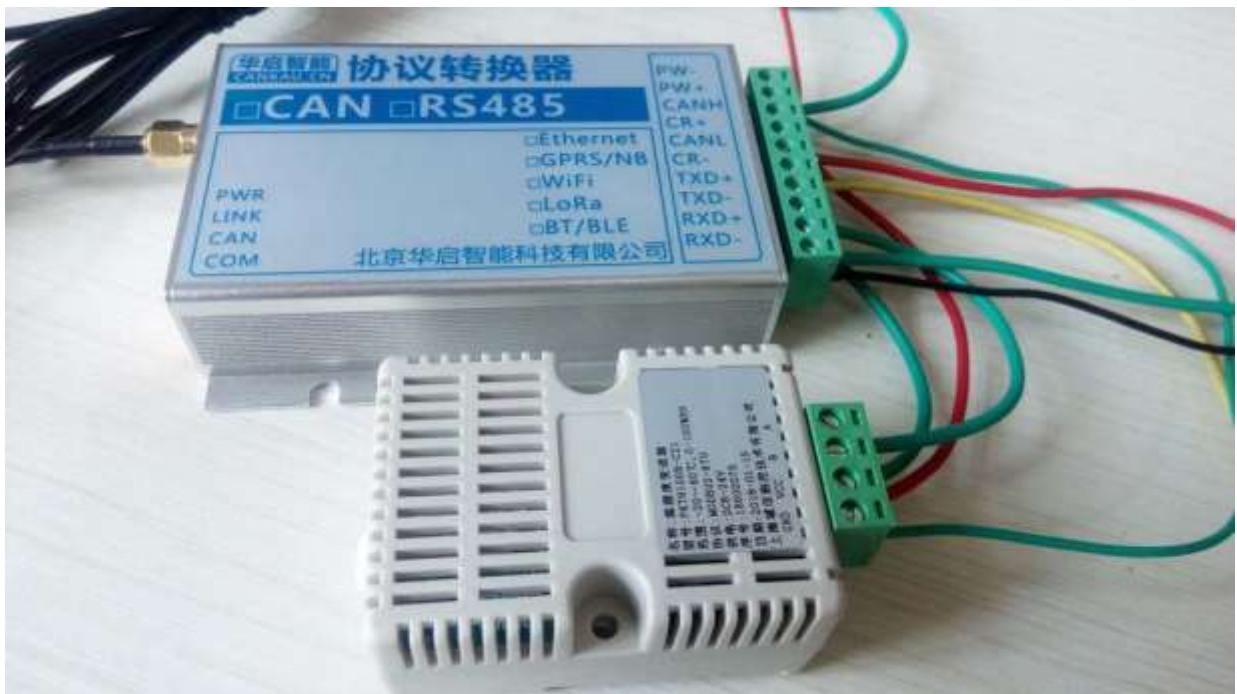
MQTT 至 MODBUS 协议转换测试实物连接图
